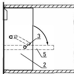
1 – строительная конструкция с нормируемым пределом огнестойкости; 2 – секции корпуса клапана; 3 – ось лопатки; 4 – воздуховод; 5 – лопатка.
